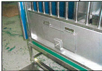
扉部 パネルは内面に斜めになっており尿や水、餌などが溜まりにくい構造になっています
